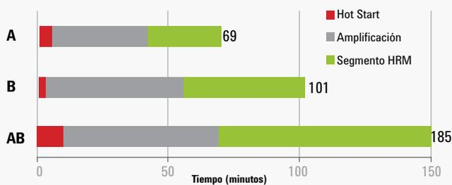
Esta gráfica muestra el tiempo requerido para identificar el SNP Rs9939609 FTO clase IV en tres instrumentos de qPCR de los competidores con las respectivas químicas para HRM de cada fabricante. Se han empleado los protocolos para HRM recomendados por el fabricante.
